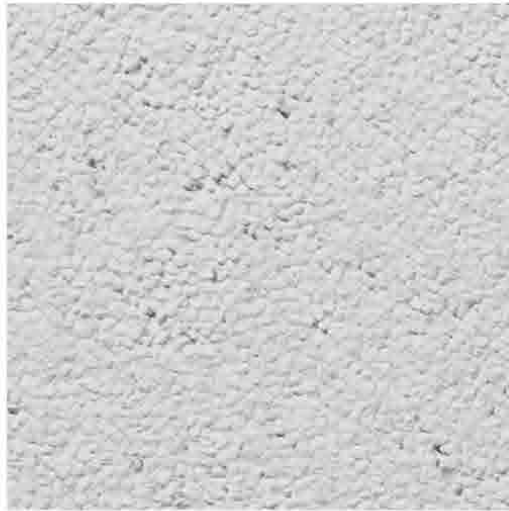
エレガント 小さな石や鉱物が見え隠れする奥行き感のある仕上げ。 仕上厚：3mm
