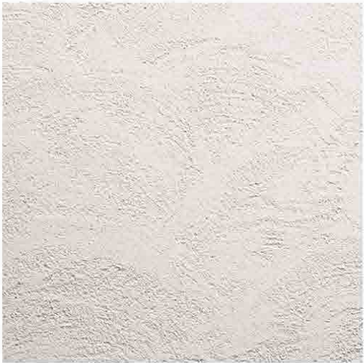
浮雲（うきぐも） ランダムに弧を描くように柄をつけ、金ゴテで表面を押さえた仕上げ。 仕上厚：3mm
